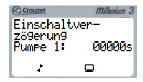
In diesem Menü können Sie die Einschaltverzögerung der Pumpe nach einem Netzausfall einstellen.
