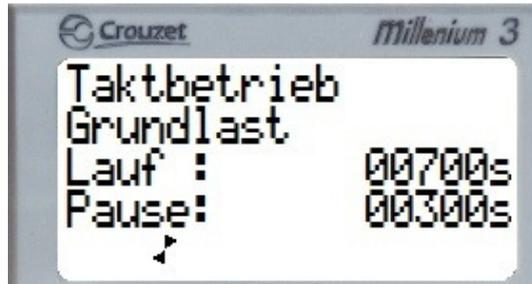
In diesem Menü können Sie den Taktbetrieb der Pumpen bei Grundlastbetrieb einstellen.
